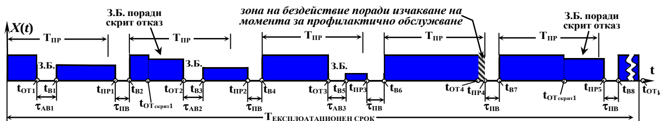
фиг. 3 Времедиаграма на блокова стратегия за техническо обслужване зависеща от момента на настъпване на отказа, без строго спазване на T_{PP}
