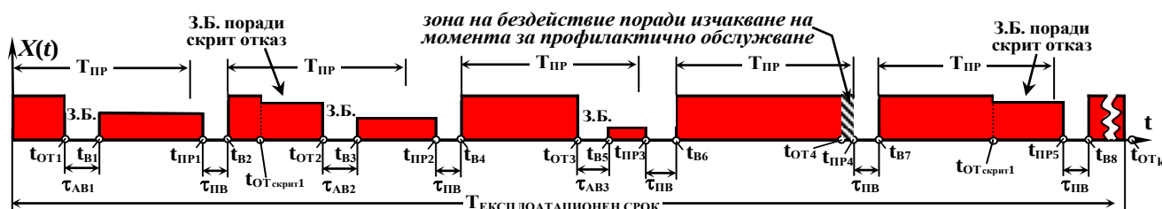
фиг. 3 Времедиаграма на блокова стратегия за техническо обслужване, с възстановявания, чийто обем зависи от момента на настъпване на отказа, без строго спазване на T_{пр}
