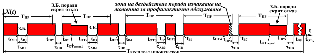
фиг. 6 Времедиаграма на блокова стратегия за техническо обслужване зависеща от момента на настъпване на отказа, с пълни аварийни възстановявания, без строго спазване на T_{ПР}
