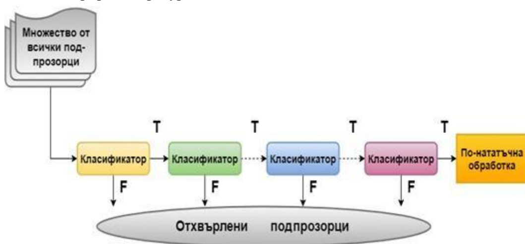
Фигура 4. Принцип на пораждаване на класификатори и отхвърляне на подпрозорци
