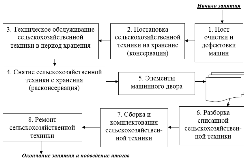
Рис. 2. Схема полигона противокоррозионной защиты сельскохозяйственной техники.
