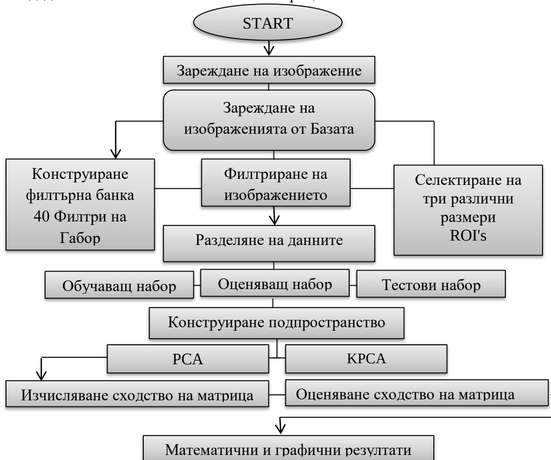
Фиг. 2 Блокова схема за тестване на процеса
