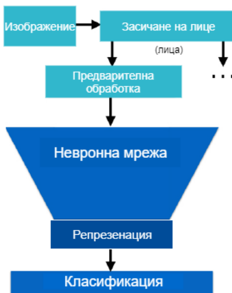
Фигура 2. Основни модули на система за разпознаване
