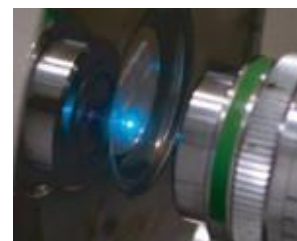
Спазер на златни наночастици за създаване на повърхностни плазмони (2009 г.)
